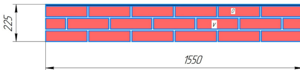
Раскладка кирпича 0 ряд
